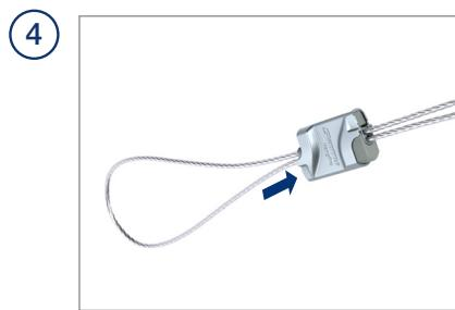
Pour régler, soutenir le poids de la charge, appuyer sur l'un des boutons afin de débloquer le câble et effectuer les réglages.
