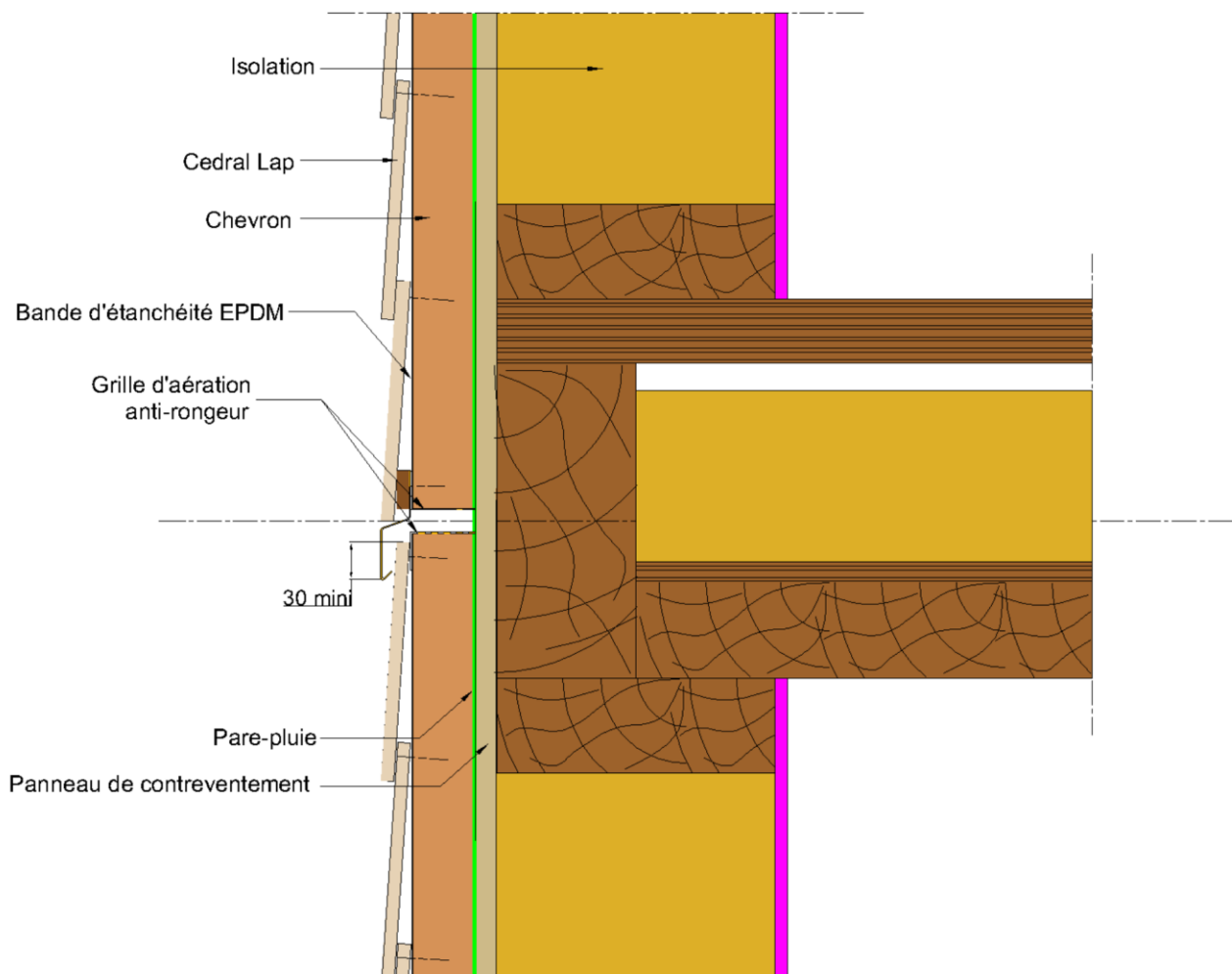
Figure 18 – Fractionnement de l'ossature au droit de chaque plancher (Pose horizontale et verticale des lames CEDRAL LAP)
