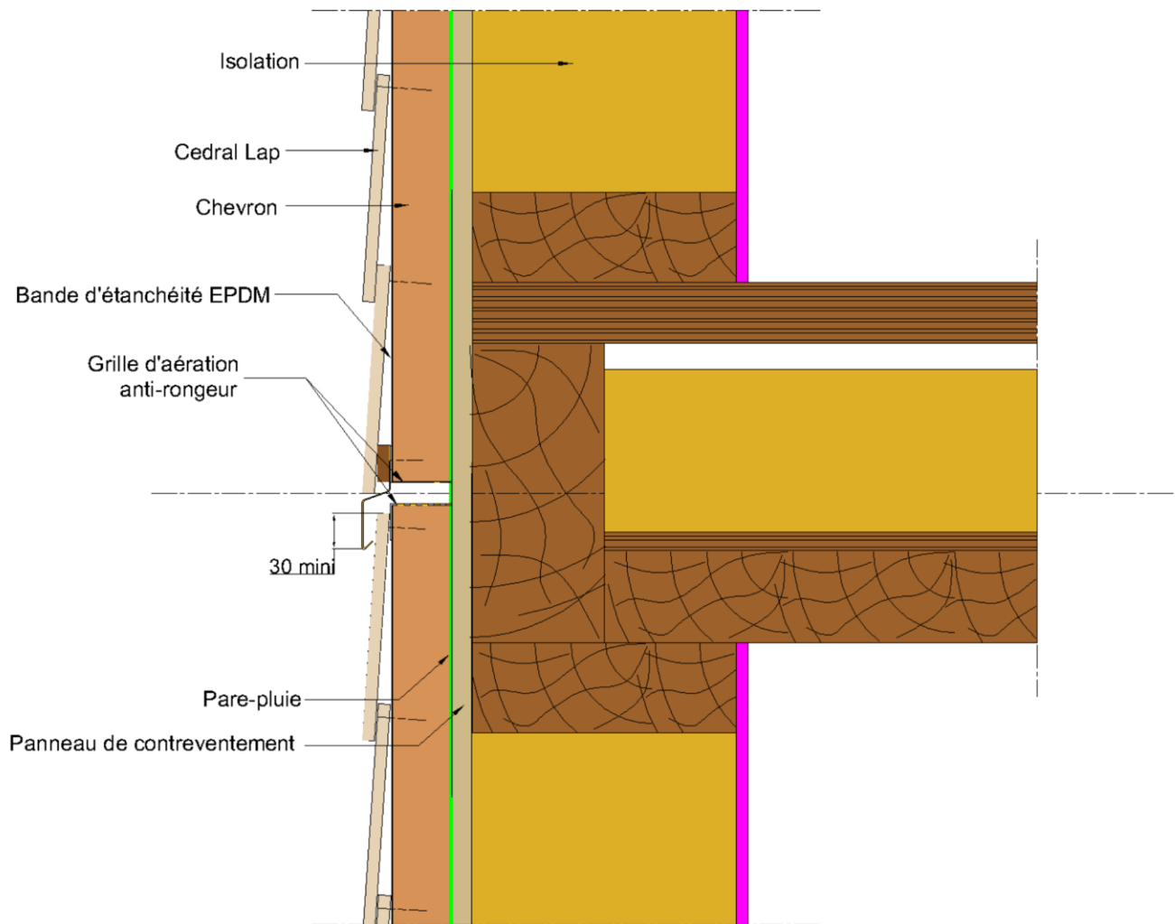
Figure A2 - Fractionnement de l'ossature au niveau de chaque plancher sur COB/CLT
