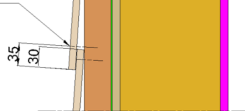
Figure 12 – Fixation Rive haute et rive basse de la lame CEDRAL LAP - Pose horizontale
