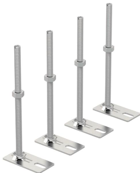
Pour le réglage en hauteur, affleurant avec le sol, des cassettes réglables en hauteur et du système de goulottes OKB affleurant avec la chape. L'unité de conditionnement se compose de 4 pieds de nivellement.
