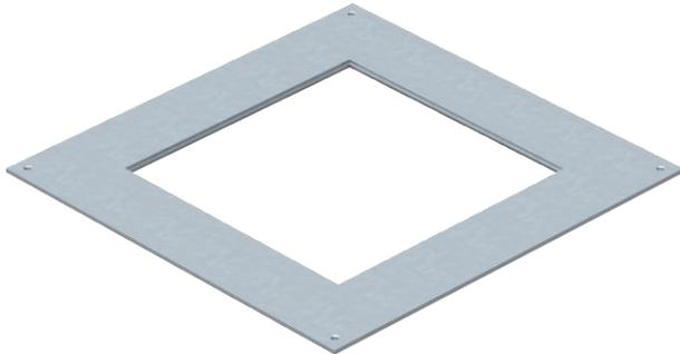
Plaque d'adaptation pour boîtes de tirage et de dérivation sous chape de type UZD250-3 destinée au montage d'un boîtier de sol de taille nominale 9. Ouverture de montage évidée de 3 mm pour la fermeture ultérieure totale à l'aide d'un obturateur.
