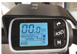
Affichage de contrôle sur la poignée
