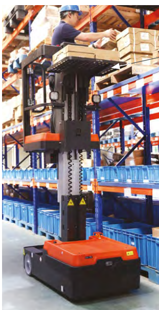
Panier de chargement jusqu'à 100 kg
