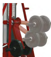
Roues positionnables en trois positions
