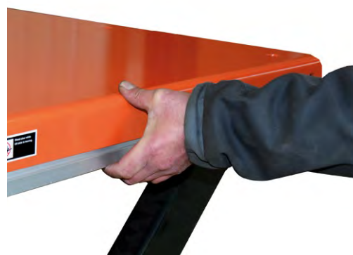
Cadre de sécurité anti-écrasement
