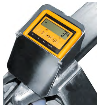
Afficheur protégé par un couvercle
