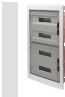
La gamme de coffrets encastrables avec protection IP40 propose des tailles allant de 2 à 72 modules, disponibles avec une porte transparente fumée (particulièrement adaptée pour le secteur commercial et industriel) ou une porte pleine (idéale pour les applications domotiques). Ils peuvent être équipés de borniers multipolaires ou unipolaires de capacité 80 A à 125 A avec câblage à vis. Ils permettent de créer un câblage simple et net en réduisant le temps d'installation du coffret.
