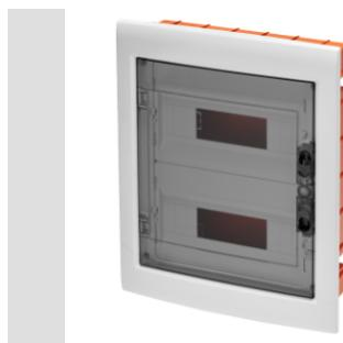
Les coffrets encastrables avec protection IP40 sont disponibles dans différentes tailles allant de 8 à 72 modules, et sont équipés de borniers multipolaires de câblage à vis, 80 A, IP20. Ils sont disponibles avec une porte transparente fumée (particulièrement adaptée pour le secteur commercial et industriel) ou une porte pleine (idéale pour les applications domotiques). Les borniers permettent de créer un câblage simple et net en réduisant le temps d'installation du coffret.
