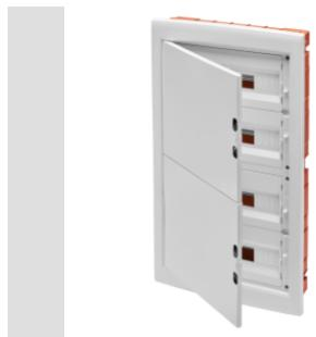
Les coffrets encastrables avec protection IP40 sont disponibles dans différentes tailles allant de 8 à 72 modules, et sont équipés de borniers multipolaires de câblage à vis, 80 A, IP20. Ils sont disponibles avec une porte transparente fumée (particulièrement adaptée pour le secteur commercial et industriel) ou une porte pleine (idéale pour les applications domotiques). Les borniers permettent de créer un câblage simple et net en réduisant le temps d'installation du coffret.
