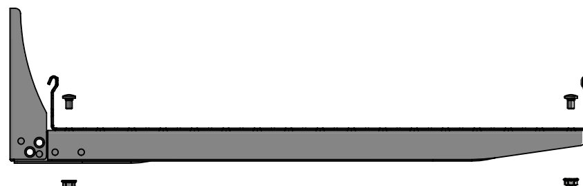
2) Boulonner le chemin de cable sur la console
