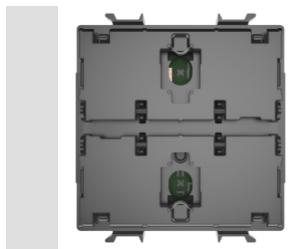
Module gradateur axial encastrable. Deux boutons-poussoirs axiaux sur la face avant pour allumer et éteindre la charge connectée (pression courte) ou pour régler la luminosité (pression longue). L'appareil doit être complété par l'un des boutons-poussoirs de la face avant. L'appareil dispose de N.3 DIP switches, situés à l'arrière de l'appareil, pour la configuration des fonctions.
