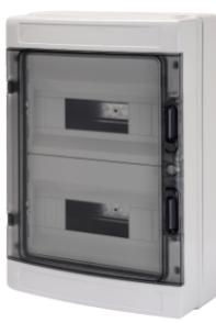
Gamme IP65 de coffrets étanches de 8 à 72 modules avec porte transparente fumée et équipés de borniers multipolaires de câblage à vis, 80 A, IP20. Les principales caractéristiques techniques sont :: façade et panneau arrière réversibles, cadres et plastrons ouverts amovibles et portes détachables avec ouverture jusqu'à 180 ° et accessoire de verrouillage. Les borniers permettent de créer un câblage simple et net en réduisant le temps d'installation du coffret.
