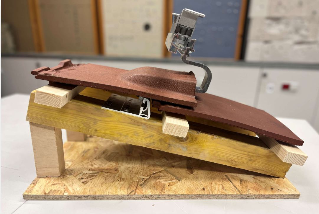
Figure 6 : Exemple de montage avec une tuile chatière
